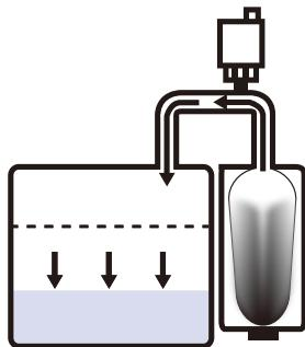
タンク内の液位が下がるとダイナクリーンからタンクへ給気され、ダイナクリーン内のブラダが収縮します。
