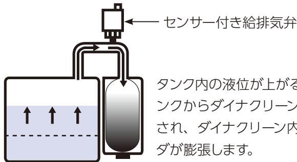
タンク内の液位が上がると、タンクからダイナクリーンへ排気され、ダイナクリーン内のブラダが膨張します。
