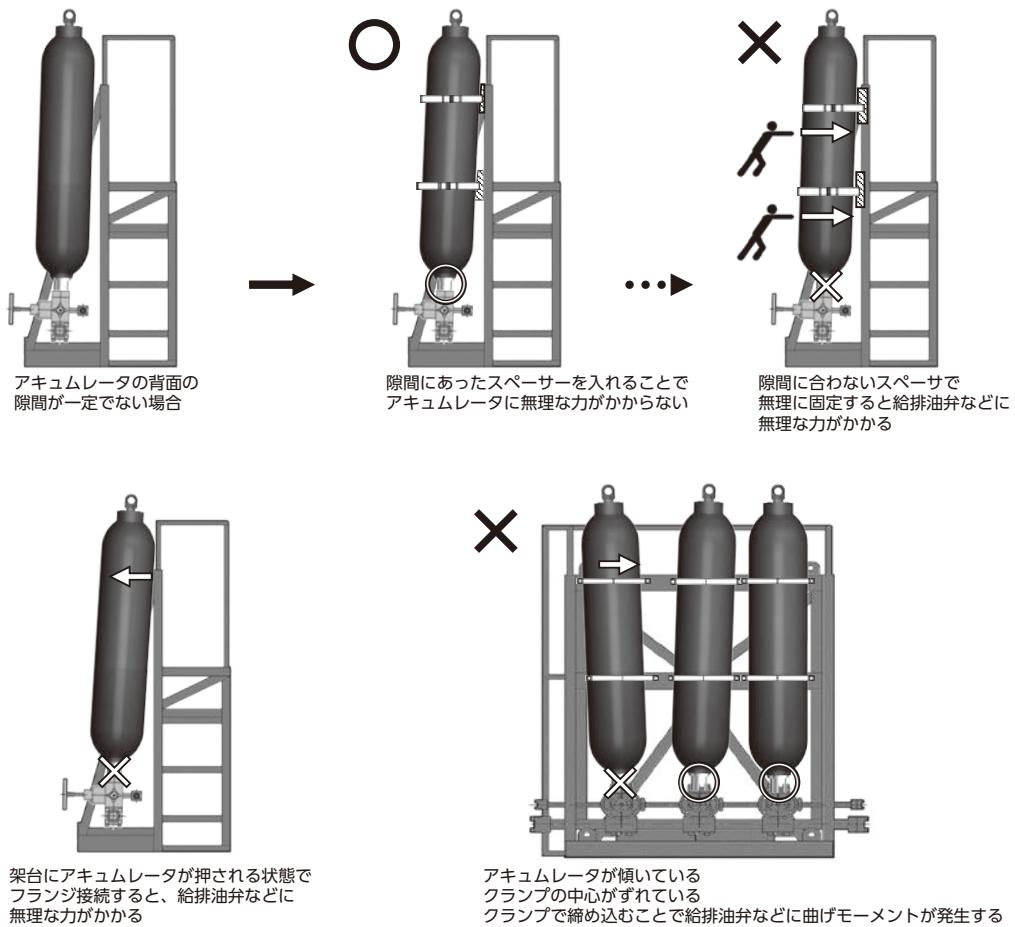
スタンドとアキュムレータの間に適正な隙間がない場合は、アキュムレータをスタンドに無理に押し付けず施工をやり直してください。無理に固定すると、配管部や給排油弁に負荷がかかり破損や漏れの原因になります。
