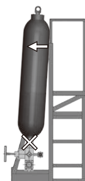
架台にアクキュレータが押される状態で フランジ接続すると、給排油弁などに 無理な力がかかる
