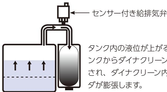
タンク内の液位が上がると、タンクからダイナクリーンへ排氣され、ダイナクリーン内のブラダが膨張します。
