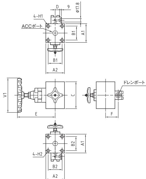
※上に示す Acc 元弁の図は 6080HFACC3210NS の形状です。
