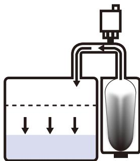
タンク内の液位が下がるとダイナクリーンからタンクへ給氣され、ダイナクリーン内のブラダが収縮します。
