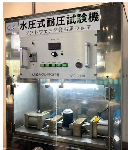
水圧式バックリング試験装置 (コンテナズラボラトリー株式会社)
