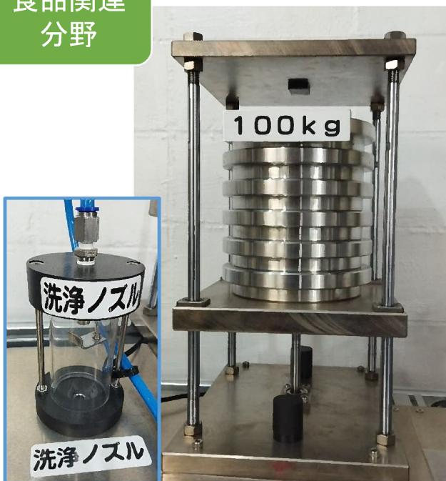
CIP洗浄機能付きリフター (水圧駆動+高圧洗浄のハイブリッド)
